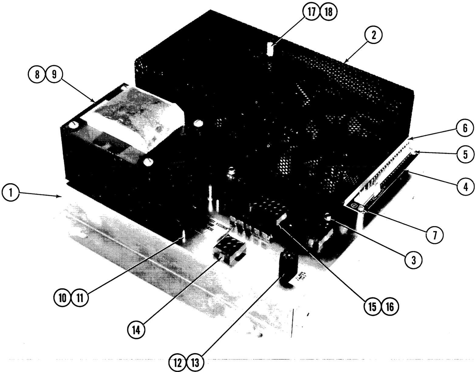
**POWER CHASSIS: 130VA (SWITCHING) PARTS LIST**
